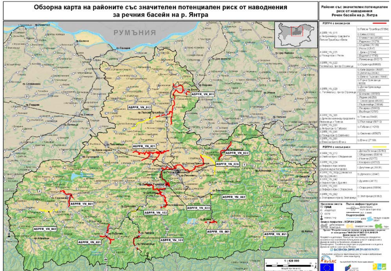
Фигура 4-13 Картосхема на речните участъци с потенциален риск за настъпване на наводнение в басейна на р. Янтра (жълто – нисък; червено – висок риск) (източник: Предварителна оценка на риска от наводнения, 2014)
